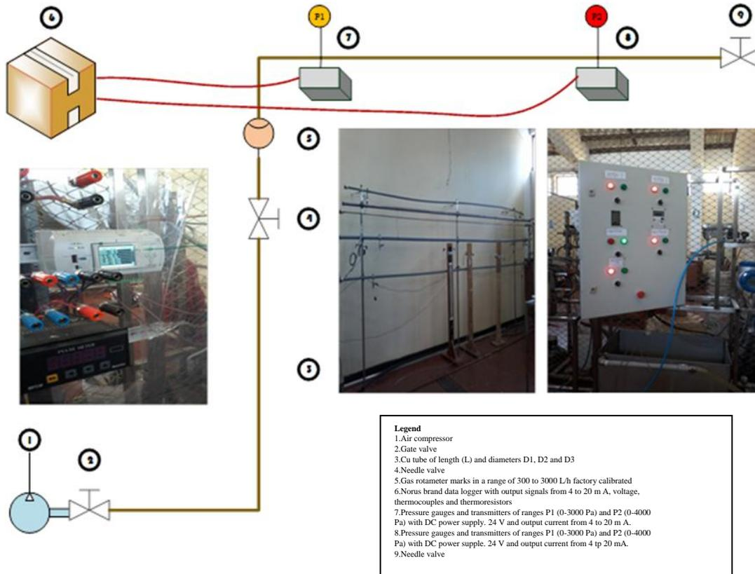
**Fig. 1.** Module diagram
